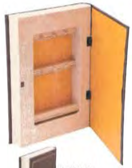
作品名「key box」 及川隼司さん(17歳)作 扉面の樹脂保護で木の小口を保護。深いラワン合板を壁に合わせ、小口が前面になるようサンディンクして雰囲気を出している。脚部も取り付けやすいボックス。ドアを流して仕上げられている。サイズは幅245×奥行50×高さ140mm
